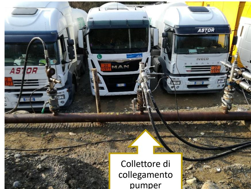
Collettore di collegamento pumper
