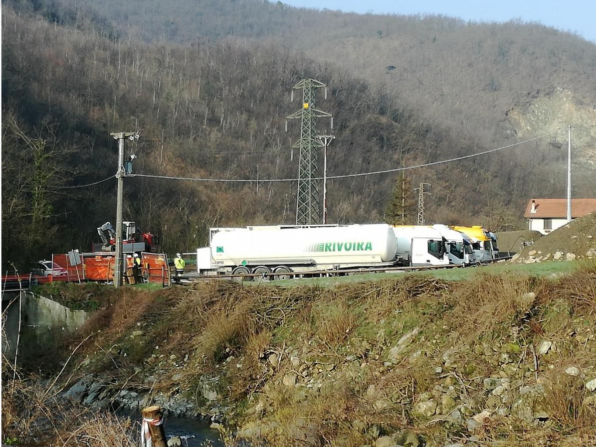
Per le notevoli portate richieste, si utilizza un pumper olandese speciale, da 18.000 mc di portata. Il pumper è compreso in una struttura montata montato su bilico, che comprende anche locale spogliatoio, cucina, ufficio e officina .
